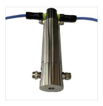
静力水准仪的系统中,所有各测点的垂直位移均是相对于其中的一点(又叫基准点)变化,该点的垂直位移是相对恒定的或者是可用其它方式准确确定,以便能精确计算出静力水准仪系统各测点的沉降变化量。特点:直线测量,位置输出,非接触式连续测量,不磨损,防护等级IP65□传感器不用重新标定,也不用定期维护,输入/输出多种选择,可选择电压、电流模拟信号输出□RS485数字信号输出。安装简单方便与其它液位变送器和液位计相比有比较明显的优势。厦门静力水准仪公司压差式静力水准仪由于结构简单、紧凑,通常使用整体铝合金外壳,具有屏蔽外界电磁干扰的作用。
