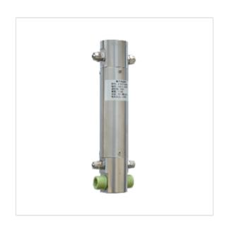
静力水准仪是一种高精密液位测量系统,该系统适用于测量多点的相对沉降。在使用中,多个静力水准仪的容器用通液管联接,每一容器的液位由磁致伸缩式传感器测出,传感器的浮子位置随液位的变化而同步变化,由此可测出各测点的液位变化量。在静力水准仪的系统中,所有各测点的垂直位移均是相对于其中的一点(又叫基准点)变化,该点的垂直位移是相对恒定的或者是可用其它方式准确确定,以便能精确计算出静力水准仪系统各测点的沉降变化量,伸缩式静力水准仪采用的传感器是利用磁致伸缩原理开发出的新一代高精度液位测量产品,是一种非接触式液位测量传感器。传感器具有高分辨率、高精度、高稳定性、高可靠性、响应时间快,工作寿命长等优点。
